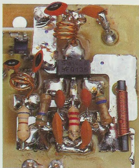
Fig.23 Anche se in questa foto le spire delle bobine L1-L2 risultano leggermente spaziate, in pratica anche se le tenete unite il rendimento non cambia.
