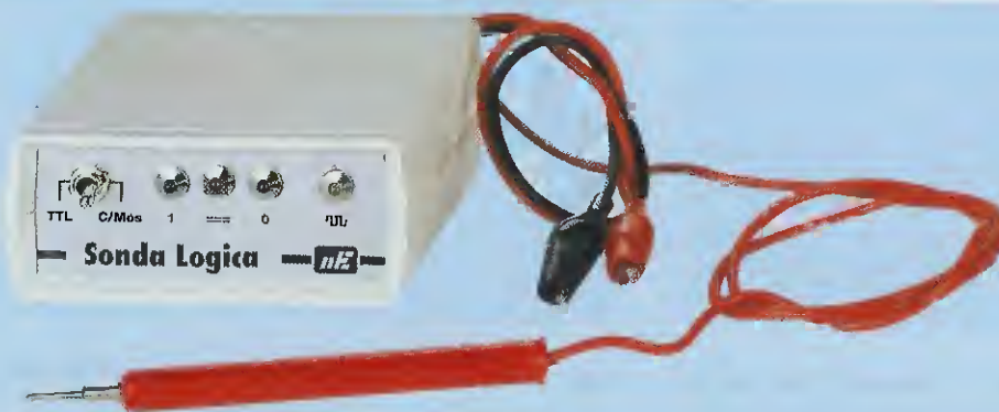
Fig.1 Foto della sonda che rivela i livelli logici degli integrati TTL e degli integrati C/Mos.
