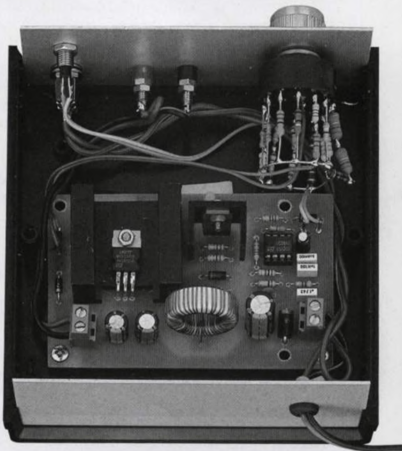
Fig.8 Foto dell'interno del mobile del caricapile. Si noti come risultano disposte le resistenze sul commutatore rotativo S1.
