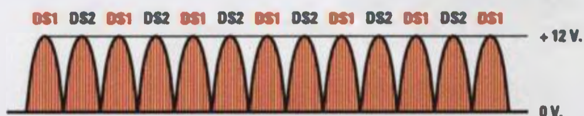
Fig.5 Per raddrizzare entrambe le semionde con due soli diodi occorre un trasformatore provvisto di un secondario con una presa centrale in grado di erogare ai due estremi il doppio della tensione richiesta. Quindi per ottenere una tensione raddrizzata di 12 volt è necessario un trasformatore da 12+12 volt.
