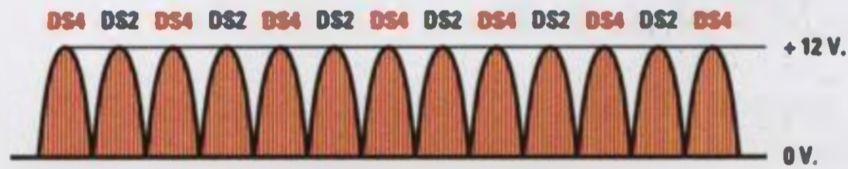
Fig.4 Quando sul terminale A è presente la semionda negativa e sull'opposto B la semionda positiva, sarà il diodo DS4 a lasciar passare dal suo Catodo le semionde positive e il diodo DS1 a lasciar passare dal suo Anodo le semionde negative. Con 4 diodi, in uscita avremo una doppia semionda positiva.
