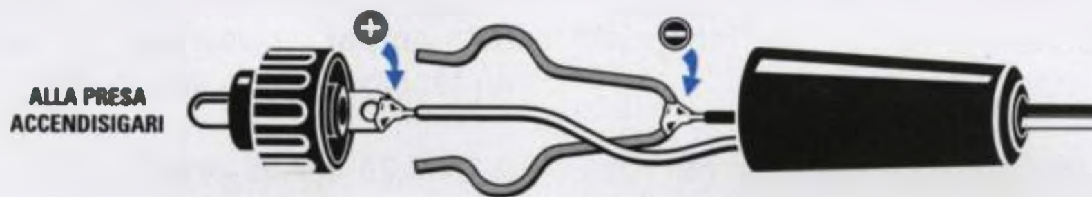
Fig.7 Nel kit, oltre ad una piattina bicolore rossa/nera, troverete anche lo spinotto maschio per l'accendisigaro. Come appare ben evidenziato nel disegno, il filo positivo va saldato sullo spinotto maschio e il filo negativo sulla forchetta ad U.
