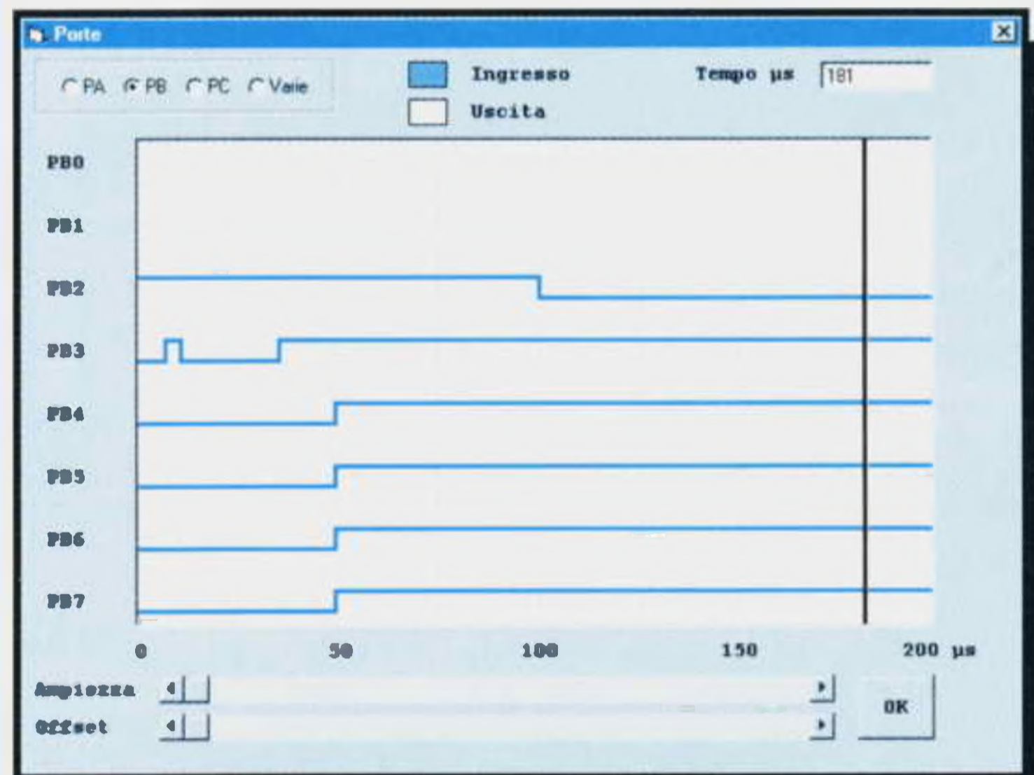
Fig.16 In questo grafico potete vedere tutti i livelli logici 1-0 che risulteranno presenti sulle porte configurate Out.
