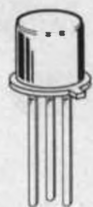
Fig.462 Se disponete di transistor metallici li potete tranquillamente usare. Nel disegno le connessioni CBE viste da sotto, cioè dal lato in cui i tre terminali fuoriescono dal corpo del transistor.
