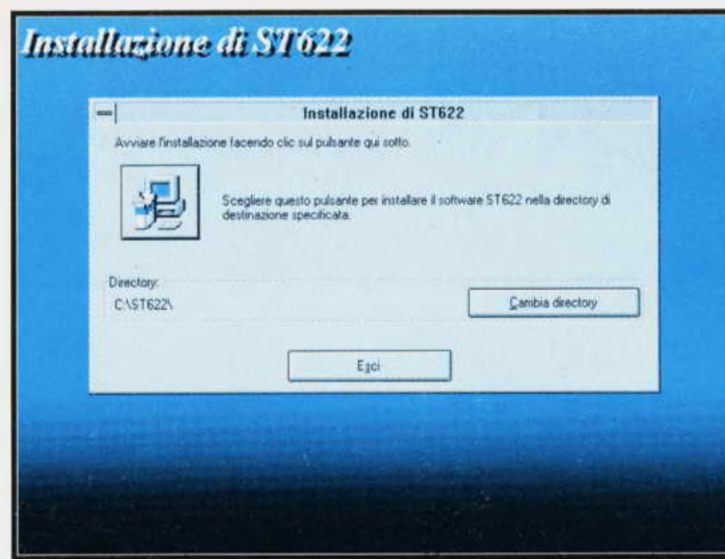
Fig.22 Letti tutti e due i dischetti, il programma d'installazione chiederà se volete cambiare oppure no la directory.
