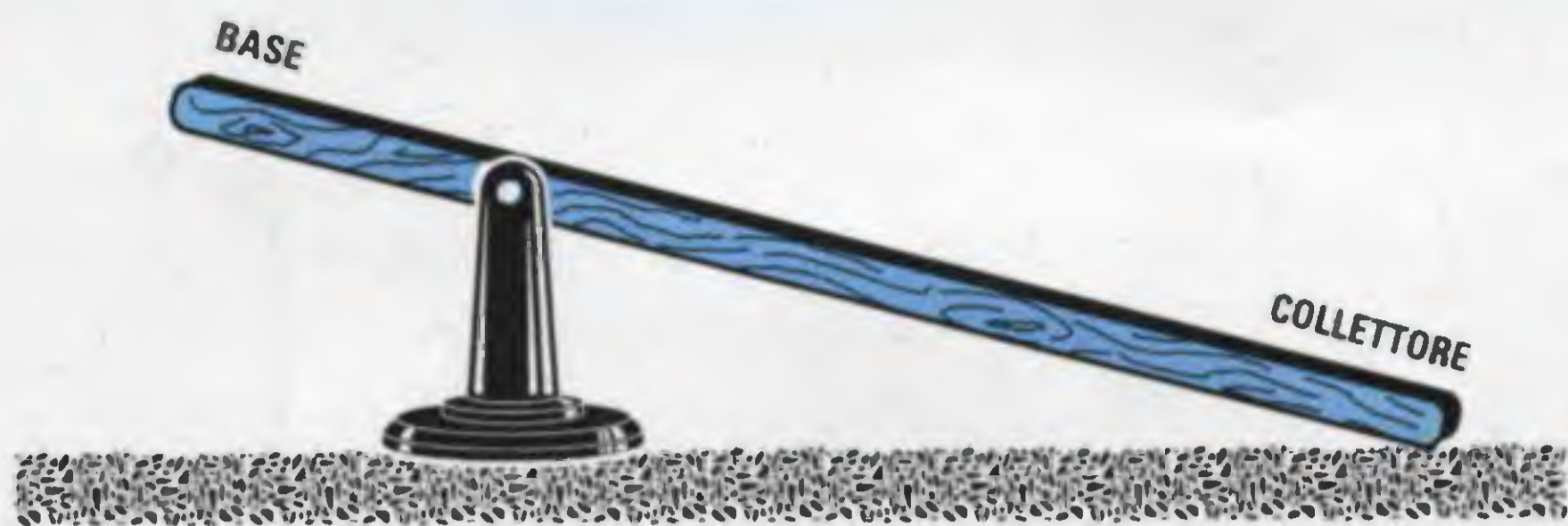
Fig.426 Per capire perchè sul Collettore deve risultare presente metà tensione di alimentazione possiamo paragonare il transistor ad una leva meccanica il cui lato corto è la Base ed il lato lungo il Collettore.
