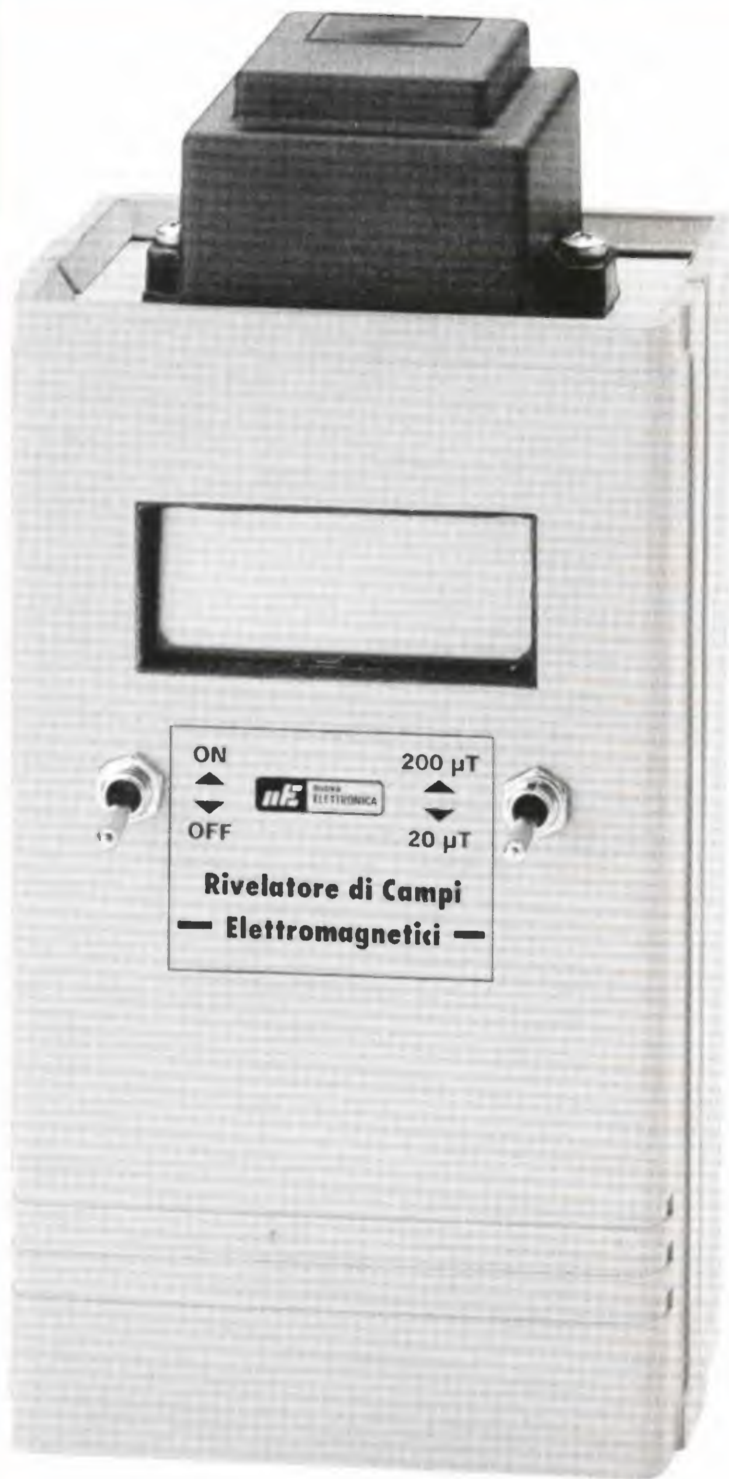
Fig.6 Ecco come si presenta il mobile del Misuratore di Campi elettromagnetici ELF. Vicino all'interruttore S2 dovreste applicare la piccola etichetta autoadesiva con la scritta 20 e 200 microtesla.
