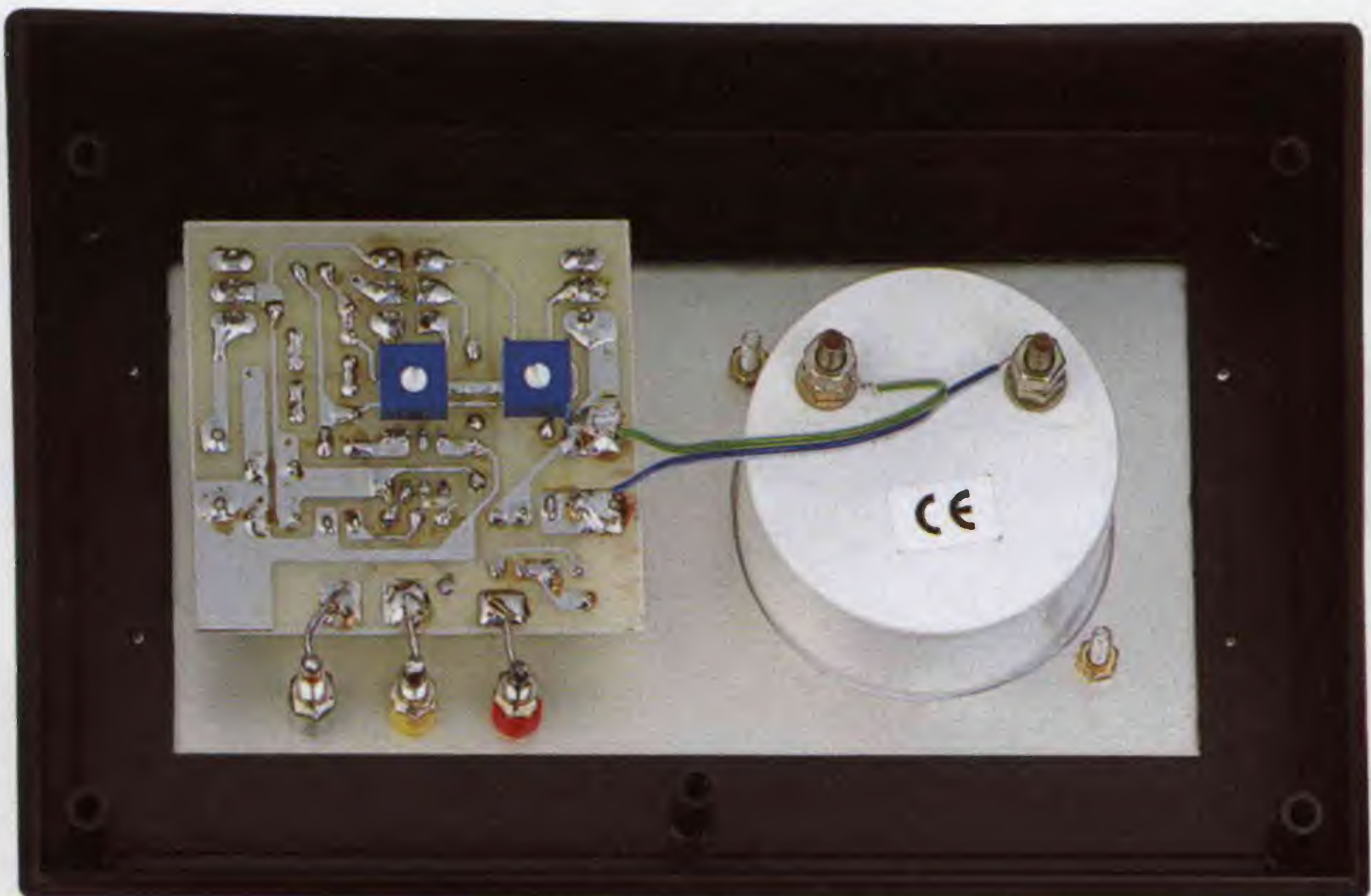
Fig.469 Per tarare il provatransistor dovete collegare assieme i due terminali A-A e le due bocche B-C, poi ruotare i cursori dei trimmer R3-R4 in modo da portare la lancetta dello strumento sullo 0. Eseguita questa operazione, togliete il filo dai due terminali A-A e ritirate i due trimmer R3-R4 in modo da portare la lancetta dello strumento sul fondo scala. A taratura completa rimettete in cortocircuito i due terminali A-A (leggere capitolo Taratura).
