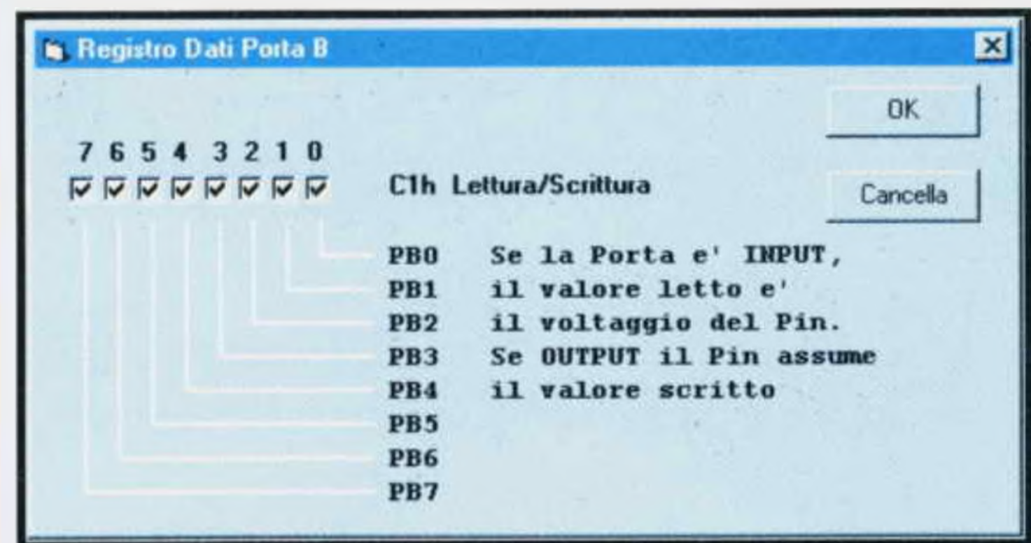
Fig.2 Automaticamente vi apparirà la finestra della mappa binaria della porta B.
