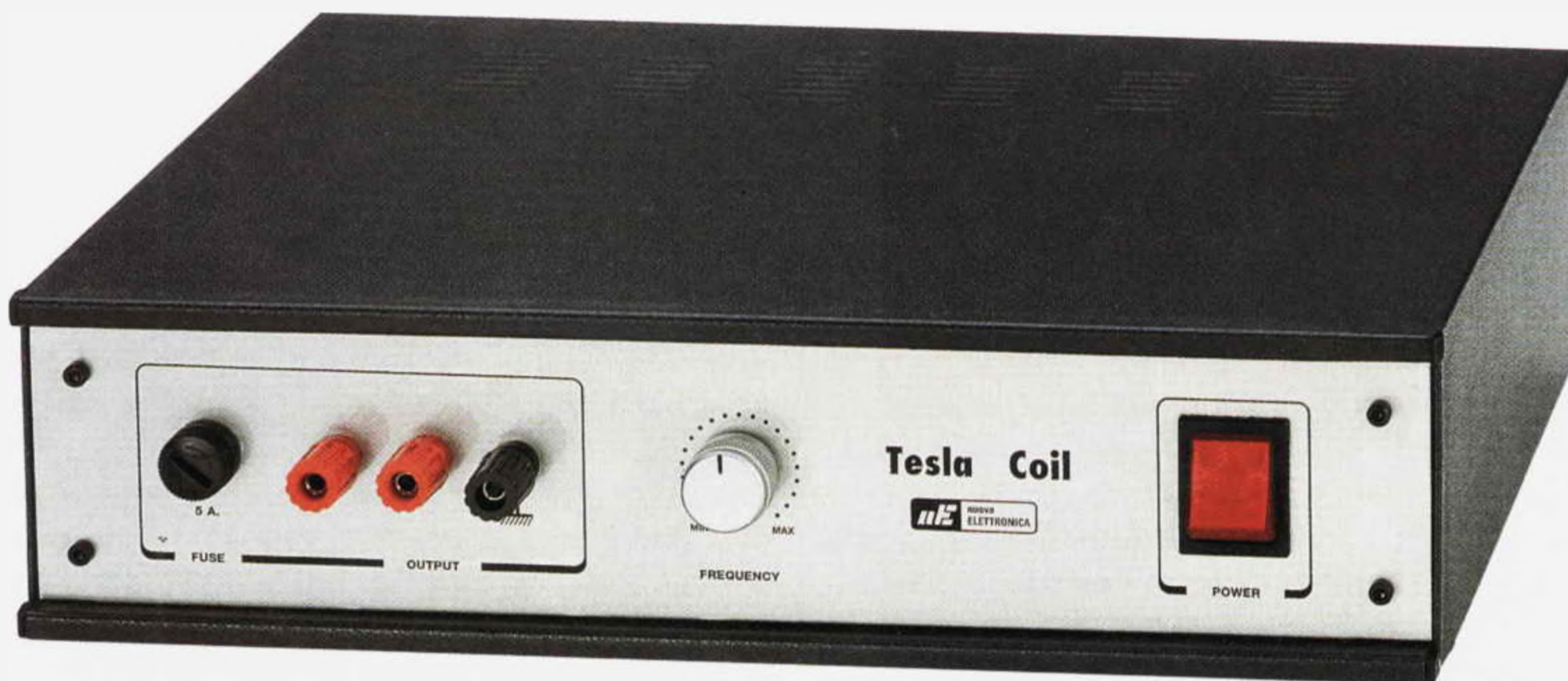
Fig.4 All'interno di questo mobile metallico andrà inserito il Generatore di onde quadre completo del suo trasformatore di alimentazione. Il morsetto di destra indicato con il simbolo "terra" andrà collegato internamente al metallo del mobile.
