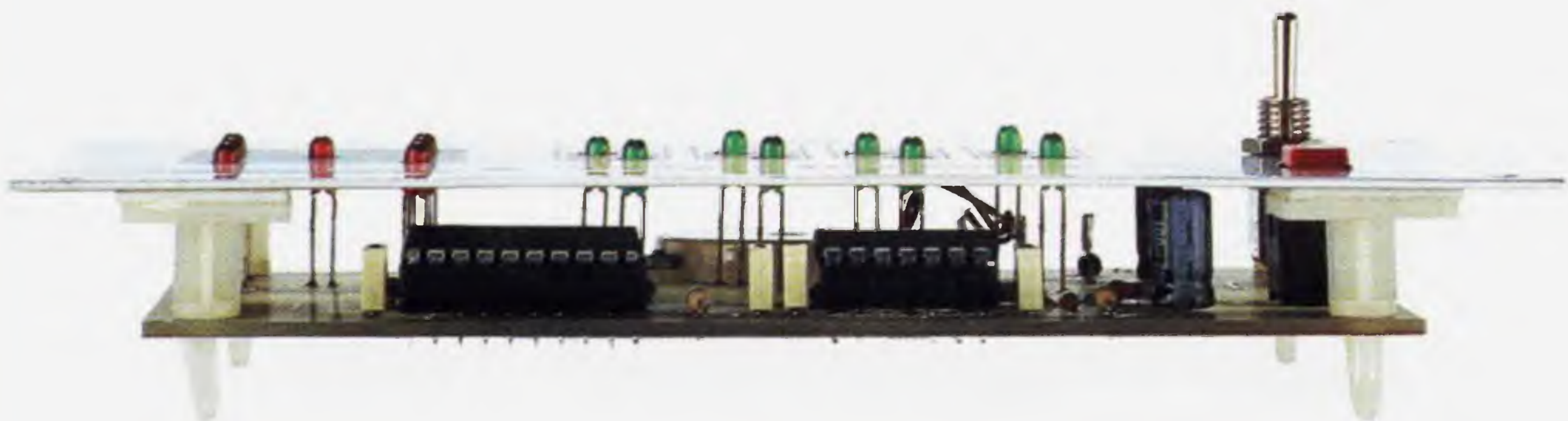
Fig.410 Una volta montati sullo stampato tutti i diodi led, inserendone il terminale più corto siglato K (vedi fig.411) nei fori che appaiono contrassegnati dalla lettera K (vedi fig.407), appoggiate sopra a questi la mascherina frontale, poi capovolgete il tutto e, dopo aver fatto fuoriuscire tutte le teste dei diodi led, saldatene con cura i terminali.
