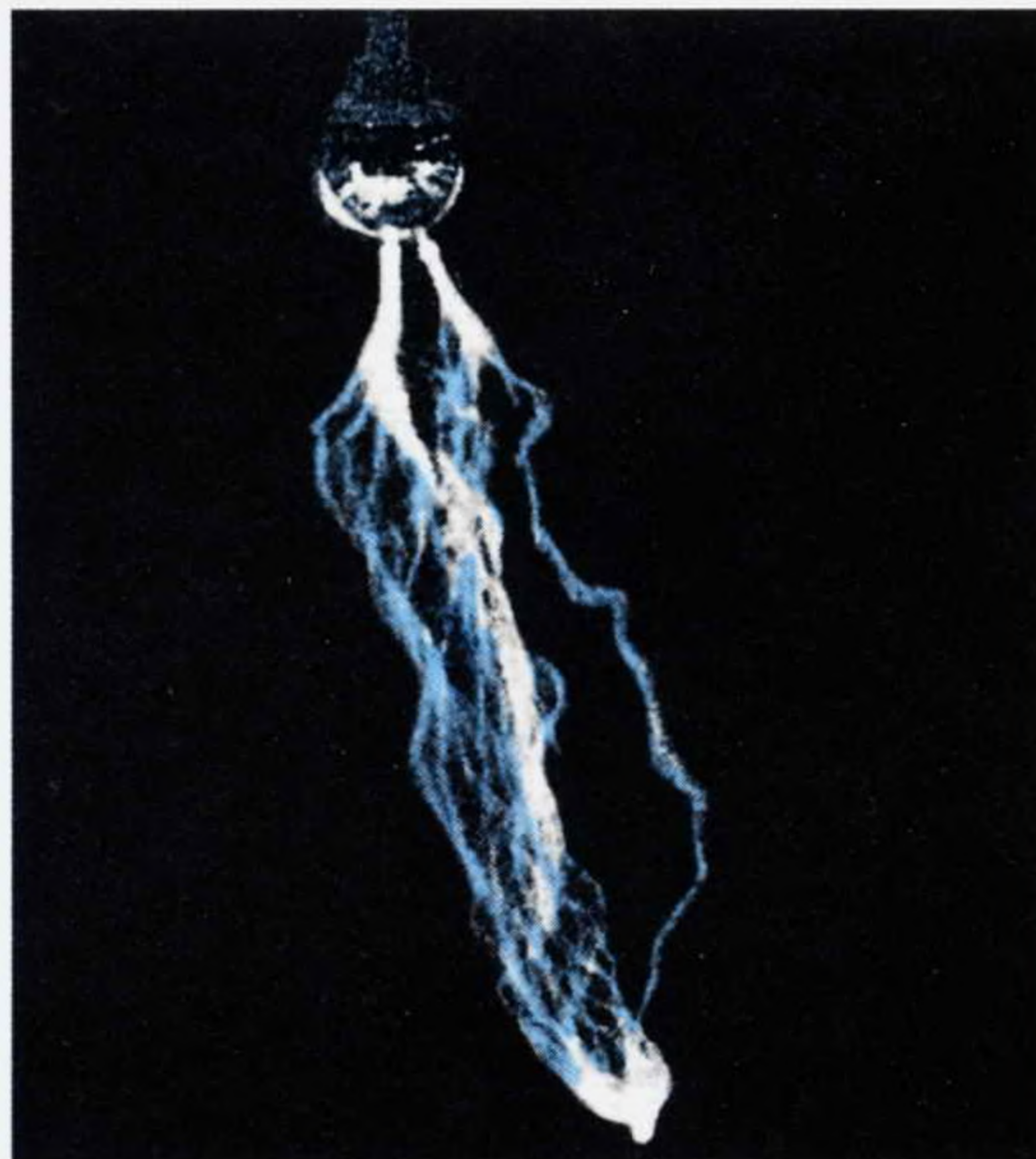
Fig.7 Se all'estremità della bobina collocerete la sola punta irradiante otterrete ugualmente delle vistose scariche elettriche che si dirameranno verso l'alto. Se in sostituzione della punta metterete 3-4 aghi otterrete delle scariche più vistose.
