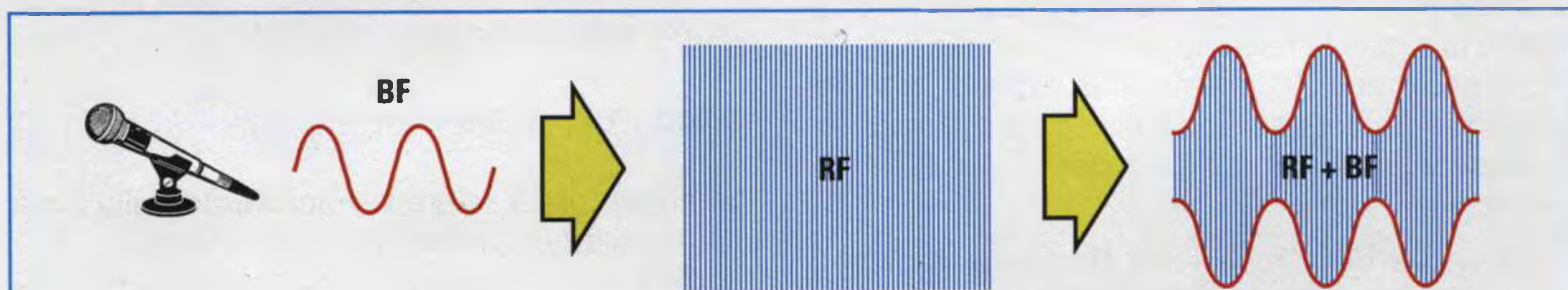
Fig.277 In tutti i trasmettitori modulati in AM (modulazione d'ampiezza) il segnale di BF prelevato da un microfono o da un registratore viene sovrapposto al segnale di Alta Frequenza. In questo modo sulle due opposte estremità del segnale RF, cioè su quella superiore e su quella inferiore, ritroviamo un "doppio" segnale di BF.
