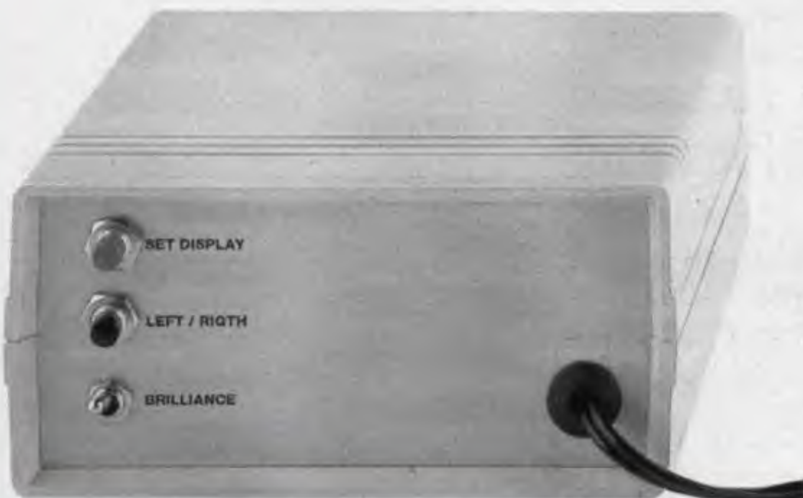
Fig.5 Il pulsante P1, che fuoriesce dal pannello, serve per la sveglia o per mettere a punto l'ora; il pulsante P2 per vedere l'ora, il giorno e l'anno.
