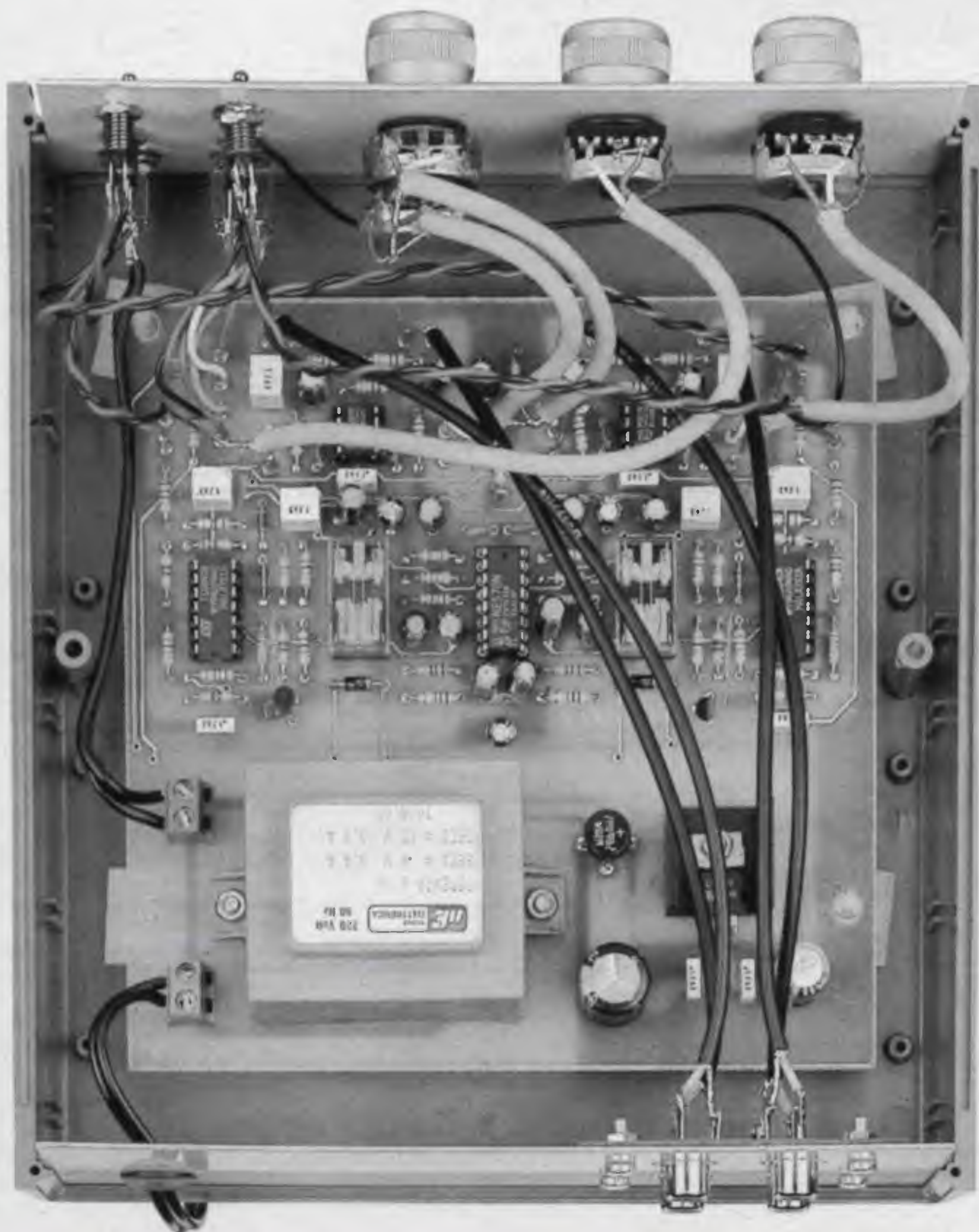
Fig.6 In questa foto un montaggio test fatto eseguire da uno studente di elettronica. Sebbene il circuito funzioni perfettamente il cablaggio è un po' disordinato. Nei montaggi da noi effettuati abbiamo fatto passare tutti i cavetti coassiali che vanno alle boccole poste sul pannello posteriore sulla destra o sotto il circuito stampato.
