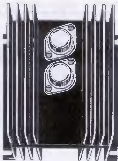
Fig.19 Se applicherete i due transistor sulle due estremità dell'aletta sottrarrete ugualmente meno calore dal loro corpo, perchè otterrete la stessa condizione che vi abbiamo illustrato in fig.16.
