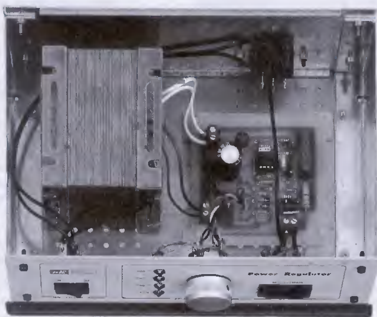
Fig.1 All'interno del mobile potrete collocare il trasformatore di alimentazione sul lato sinistro ed il circuito stampato LX.1217 sul lato destro, utilizzando per il fissaggio i distanziatori plastici che troverete nel kit. I fili dei 220 volt del trasformatore sono quelli di colore Nero, quelli dei 260 volt sono di colore Rosso e i fili degli 8 volt sono di colore Bianco.
