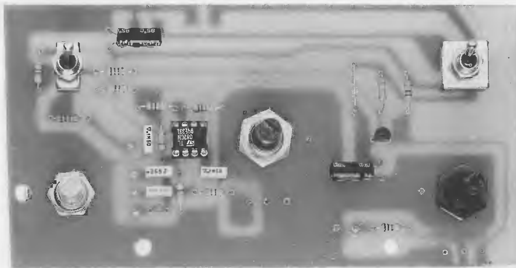
Fig.5 Foto dello stampato LX.1151 con sopra già montati tutti i componenti. I due condensatori elettrolitici C4-C6 andranno collocati in posizione orizzontale, diversamente non riuscirete a fissare lo stampato al pannello frontale. Si noti il ponticello in filo di rame posto vicino alla resistenza R10.
