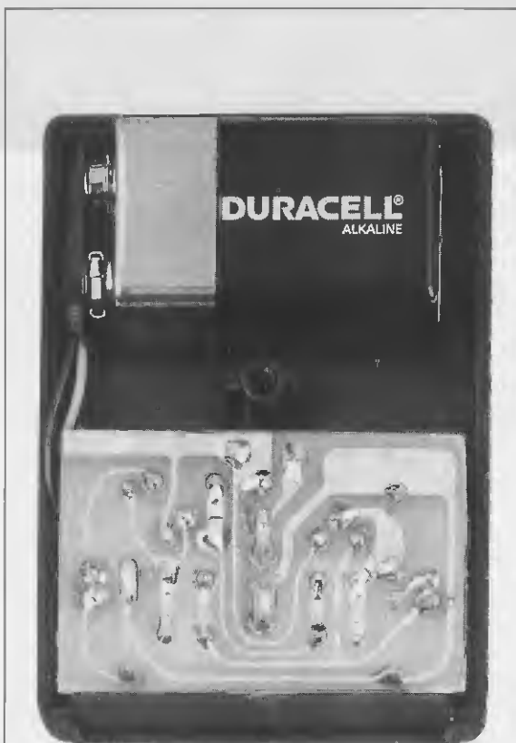
Fig.6 Il circuito stampato verrà bloccato all'interno del mobile plastico con il dado dell'interruttore di accensione S1. Nello spazio posto in alto applicherete la pila di alimentazione da 9 volt. Il coperchio è completo di una clip che potrà servirvi per agganciarlo alla cintura.
