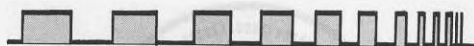
Fig.2 Dai due piedini di uscita A o B fuoriescono delle onde quadre la cui frequenza è proporzionale alla velocità di rotazione del perno. Se il perno ruota lentamente, otterrete una frequenza molto bassa, se il perno ruota velocemente, otterrete una frequenza molto elevata.
