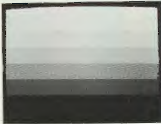
Fig.10 La scala orizzontale dei grigi vi serve per controllare la linearità dell'amplificatore verticale. Se questo non è lineare le fasce avranno diverse larghezze.
