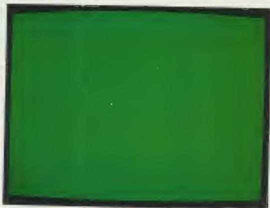
Fig.15 Lo schermo tutto VERDE vi serve per controllare se la convergenza dei colori è perfetta. Se così non fosse vedreste apparire delle macchie di diverso colore.
