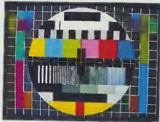
Fig.40 Se vedete un monoscopio con dei colori sbiaditi, occorre regolare i comandi del contrasto e della luminosità del televisore in modo da ottenere i colori di fig.39.
