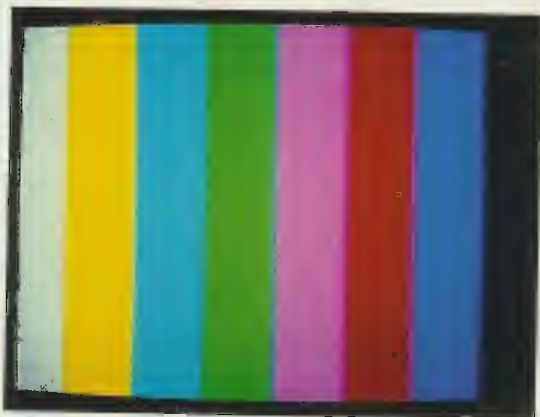
Fig.13 Le barre verticali a colori vi permettono di controllare se la luminosità di ogni barra viene riprodotta fedelmente in verticale, senza presentare macchie.
