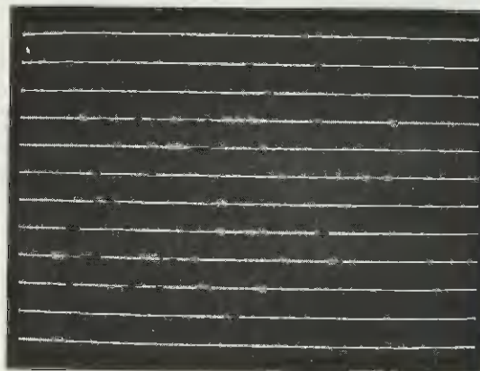
Fig.6 Le linee orizzontali in bianco/nero servono per controllare se la linearità e la focalizzazione in senso orizzontale sono perfette. Le righe devono apparire nitide.
