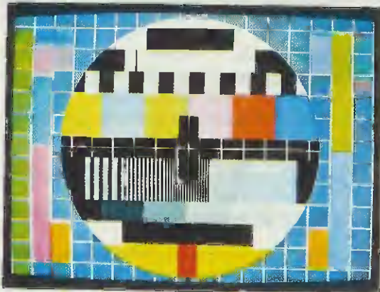
Fig.43 Se il demodulatore PAL non è ben tarato, vedrete dei colori sulla parte superiore delle fasce laterali a C (osservate la differenza tra questa e la fig.39).
