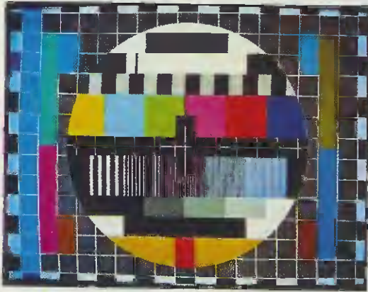
Fig.39 Se sul perimetro dell'immagine appare una "scacchiera" significa che non sono ben tarati i trimmer dell'ampiezza orizzontale e verticale del televisore.
