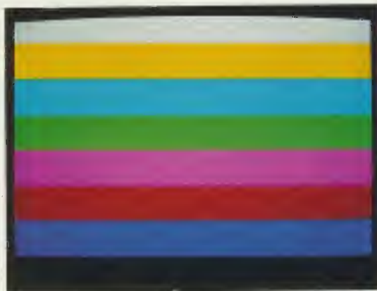
Fig.12 Le barre orizzontali a colori servono per verificare se il contrasto dei colori è ben regolato e per stabilire se il cinescopio riproduce la scala dei colori.
