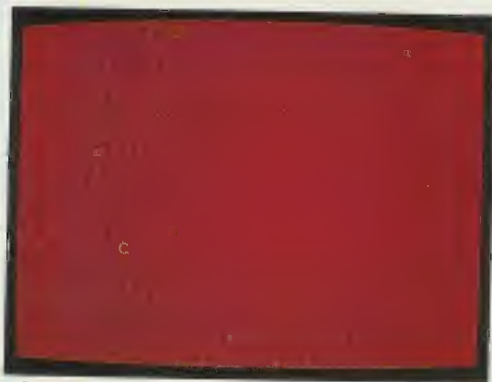
Fig.14 Lo schermo tutto ROSSO vi serve per controllare se la convergenza dei colori è perfetta. Se così non fosse vedreste apparire delle macchie di diverso colore.
