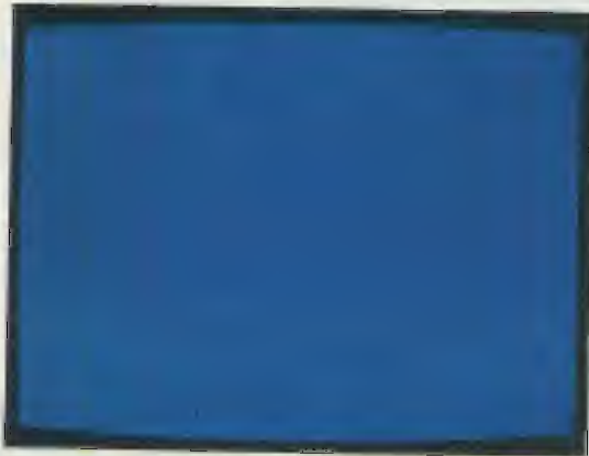
Fig.41 Se nel quadro del colore BLU sono presenti delle striatura di colore da un solo lato, significa che vi sono delle interferenze tra l'AUDIO e la portante CROMA.
