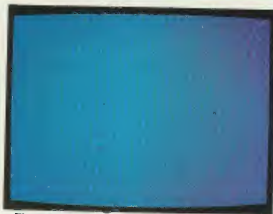
Fig.16 Lo schermo tutto BLU vi serve per controllare se la convergenza dei colori è perfetta. Se così non fosse vedreste apparire delle macchie di diverso colore.
