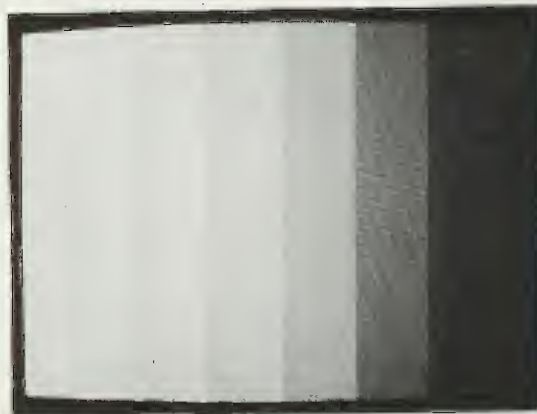
Fig.11 La scala verticale dei grigi serve per controllare la luminosità ed il contrasto. A destra dovrete vedere un nero intenso e a sinistra un bianco pulito.
