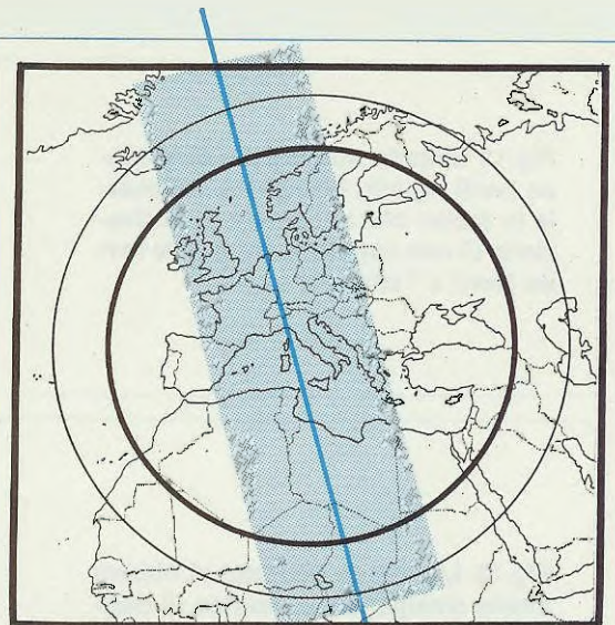
Fig.16 Poiché l'orbita di ogni satellite risulta inclinata rispetto ai due punti cardinali Nord-Sud, con le orbite ascendenti il satellite giungerà da Sud/Est per proseguire verso Nord/Ovest, quindi sullo schermo vedremo ad esempio prima l'Egitto e la Libia, poi il sud dell'Italia quindi il nord e, proseguendo, l'Inghilterra.
