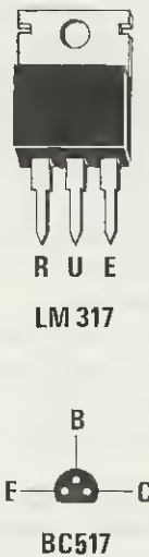
Fig.2 Connessioni dell'integrato stabilizzatore LM.317 e del transistor Darlington BC.517 visto da sotto.
