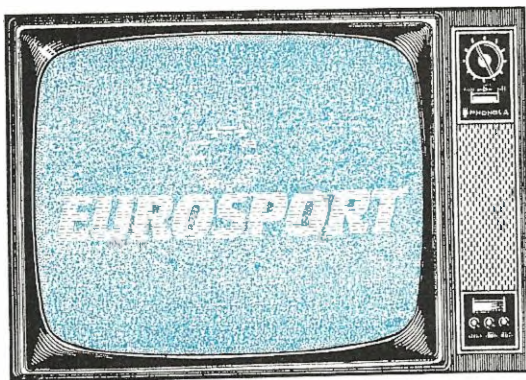
Fig.1 Quando il segnale captato è insufficiente, le immagini risultano scadenti per la presenza di molto "rumore". I fattori che possono influenzare negativamente la qualità dell'immagine sono: un diametro di parabola insufficiente, un convertitore LNC con elevata cifra di rumore (scegliere LNC con NF minore di 1,7), un errore nel puntamento del satellite o del "punto focale".
