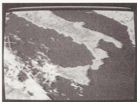
Fig.9 In questa foto vi facciamo vedere una immagine della Sicilia già ingrandita con lo Zoom 1. Come già saprete questo è il massimo ingrandimento che il nostro Videoconverter permette di ottenere.
