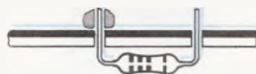
Fig.4 Se notate che lo stagno fuso non si spande sulla pista del circuito stampato e rimane opaco e rugoso, la saldatura non è perfetta. Lo strato di ossido, non dimenticatelo, è una resistente pellicola "isolante" che dovrete necessariamente eliminare.
