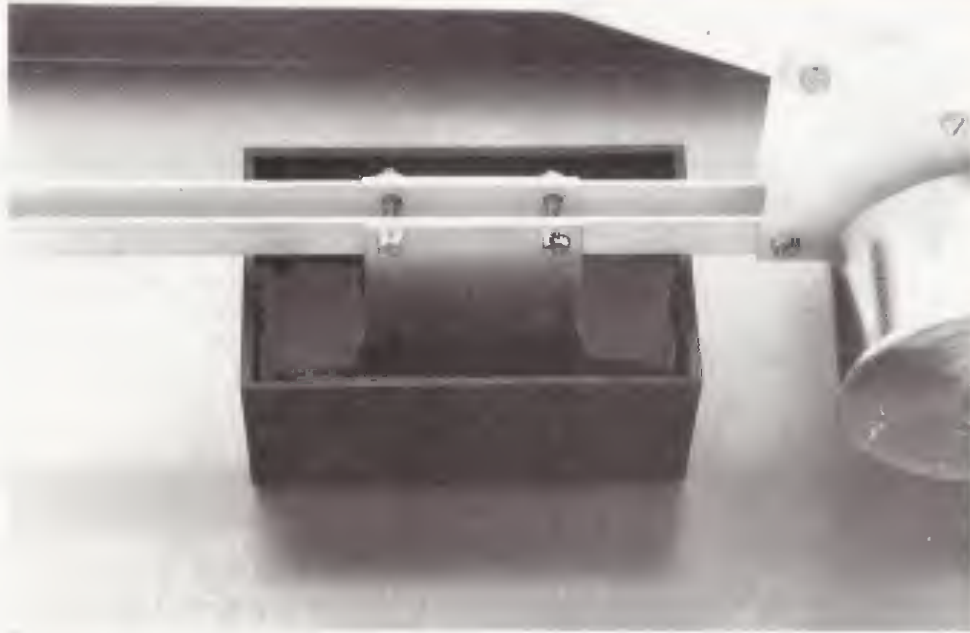
Fig.30 All'interno della vaschetta in plastica dovreste versare un pò di olio Multi-grade per auto, fino a raggiungere i due fori di riferimento. Se metterete più olio il pendolo risulterà troppo ammortizzato.
