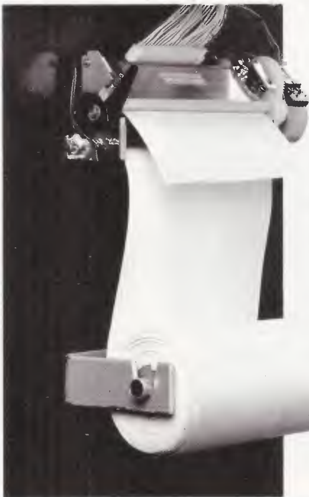
Fig.15 La carta verrà inserita nella fessura inferiore e come noterete uscirà da quella superiore. Vi ricordiamo che la carta dispone di un solo lato sensibile, quindi se la inserirete in senso inverso non riuscirete a registrare alcun sismogramma. Se l'avrete inserita nel giusto verso, premendo il pulsante Reset vedrete apparire le due lettere NE.
