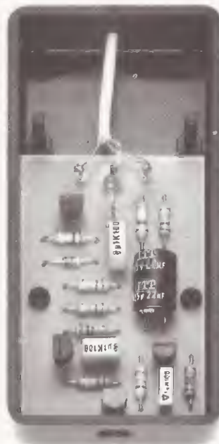
Fig.15 Lo stadio ricevente LX.925 verrà racchiuso in un identico contenitore plastico. Su questo, oltre al foro per il fotodiode ricevente ed il cavetto di alimentazione, dovrete praticare sul coperchio anche un foro per il diodo led.
