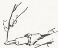
Fig.2 Chi scioglie lo stagno sulla punta del saldatore, non riuscirà mai ad ottenere delle saldature perfette, perchè il disossidante in questo caso servirà solo per pulire la superficie del saldatore e non per "bruciare" l'ossido sulle superfici da saldare.
