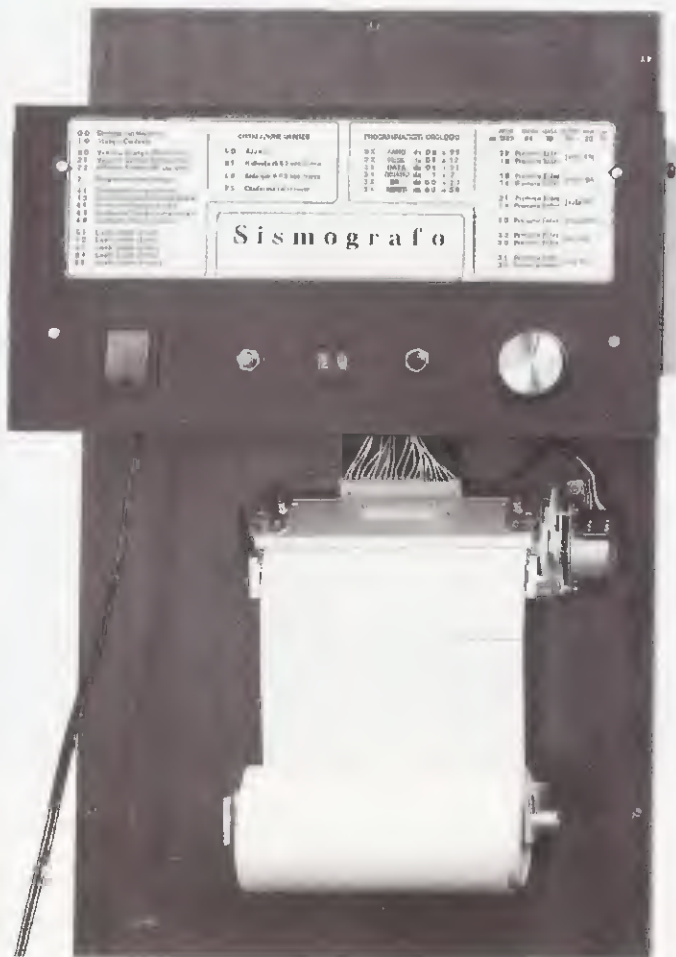
Fig.40 La tavoletta di legno sulla quale avrete fissato lo stampato LX.923, la stampante con delle viti in legno ed il supporto per la carta termica (vedi fig.17), la potrete fissare verticalmente su una parete. Così facendo la carta potrà facilmente scendere e venire raccolta entro una scatola di cartone.
