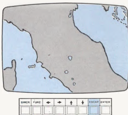
Fig. 26 Premendo il tasto ESCAPE, ogni volta che udrete 3 "beep" si ingrandirà sempre del doppio l'immagine centrale "A" (vedi fig.25).
