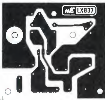
Fig.3 Dimensioni a grandezza naturale del circuito stampato, visto dal lato rame. Questo circuito in fibra di vetro, porta la sigla LX.837.
