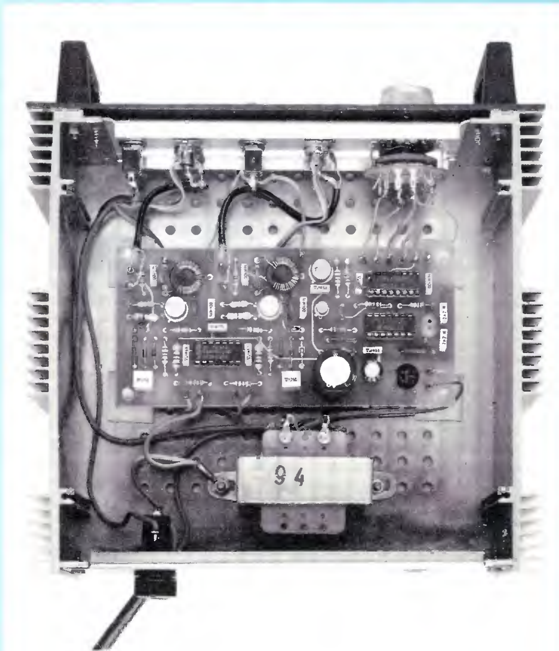
Fig.14 Il circuito stampato verrà fissato all'interno del mobile utilizzando i quattro distanziatori con base autoadesiva. Inseriti i perni plastici di tali distanziatori nei fori dello stampato, toglieremo da sotto le basi la carta protettiva per l'adesivo. Vi ricordiamo che il filo che fa capo allo spinotto centrale del cordone di rete andrà collegato al metallo del mobile, utilizzando la vite di fissaggio del trasformatore di alimentazione.
