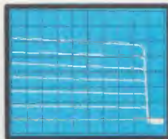
Fig. 13 Se infine notassimo che le curve anziché risultare disposte come vedesi in fig. 10, risultano disposte in modo «speculare», cioè da destra verso sinistra, sarà sufficiente spostare sul circuito stampato i ponticelli P1 e P2.
