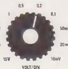
Fig. 19 Posizionando questa stessa manopola nella posizione 0,2 volt x divisione, dovremo raddoppiare la corrente indicata sui tre commutatori visibili in figura.
