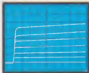
Fig. 43 La corrente di Base idonea sarà quella che ci permetterà di visualizzare sullo schermo dell'oscilloscopio tutte e 6 le tracce come vedesi in questa figura.
