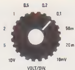
Fig. 18 Ruotando la manopola dell'oscilloscopio nella posizione 0,1 volt x divisione, sulla scala verticale avremo per quadretto la stessa corrente riportata sui commutatori.
