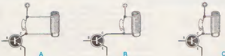
Fig. 1 Realizzando un qualsiasi oscillatore di AF dovreste ricordarvi di tenere il più vicino possibile il condensatore di accordo alla bobina di sintonia. Delle tre figure riportate, la A e la B rappresentano due collegamenti da evitare, mentre la C quello corretto.
