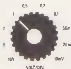
Fig. 22 Per calibrare sullo schermo dell'oscilloscopio la «tensione» di collettore, dovremo ruotare la manopola volt/div. sulla portata 1 volt come vedesi in figura.
