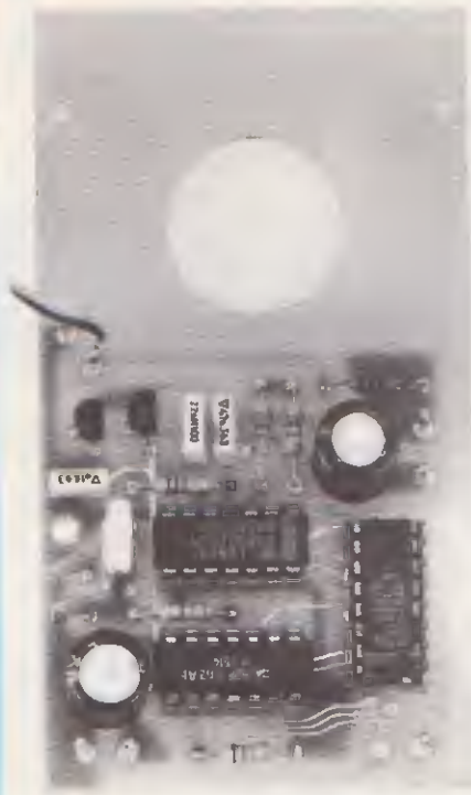
Fig.4 Il foro circolare visibile nella parte superiore del circuito stampato, ci serve per innestarvi il corpo dell'altoparlante. Se necessario, potremo utilizzare una goccia di collante affinché questa non si muova.
