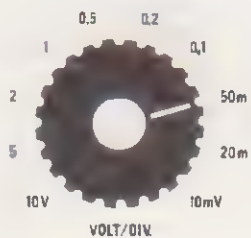
Fig. 20 Se ruoterete questa manopola sulla portata 50 millivolt x quadretto, si dimezzerà la corrente sulla verticale dello schermo. La posizione consigliata è quella di fig. 18.
