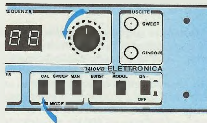
Fig. 26 Per sapere a quale frequenza corrisponde un qualsiasi punto di queste due curve, dovrete pigiare il pulsante CAL, quindi leggere sul display la frequenza generata come già spiegato in fig. 20.
