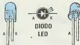
Fig. 2 Qualsiasi tipo di diodo led vorrete utilizzare, piatto, normale o miniatura, ricordatevi sempre che il terminale più lungo è l'Anodo ed il più corto il Catodo. Le connessioni dei due transistor BC328 e del Darlington BC517 sono identiche.
