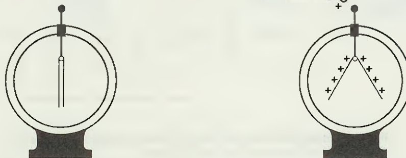
Fig. 1 Per rilevare l'elettricità statica si è sempre usato l'elettrometro, cioè una bottiglia sottovuoto contenente due piccole pagliette d'oro. Avvicinando una bacchetta di plastica, sfregata precedentemente con un panno, le due pagliette si respingevano.
