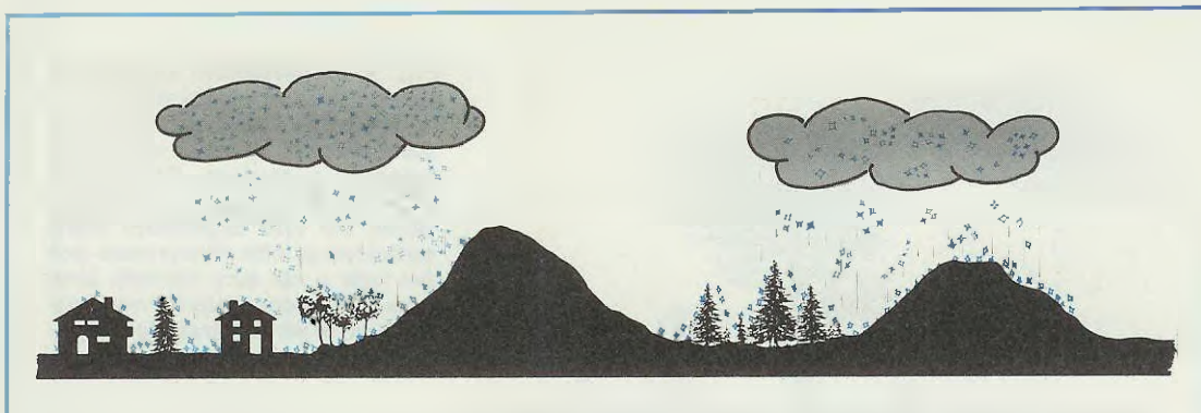
Fig. 8 È facilmente comprensibile perchè tra due zone adiacenti si possano rilevare notevoli differenze di radioattività. Infatti, se una nuvola carica di pulviscolo radioattivo lascia cadere sulla zona A una quantità notevole di acqua, al suolo si avrà una elevata concentrazione di radioattività. Se la stessa nuvola, ormai priva del pulviscolo che ha scaricato sulla zona A, si sposta nella zona B, non potrà, anche in caso di una pioggia prolungata, rendere radioattivo il terreno sottostante.
