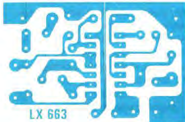
Fig. 5 Disegno a grandezza naturale del circuito stampato necessario per realizzare questo semplice ma preciso provaquarzi.
