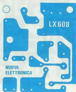
Fig. 3 Disegno a grandezza naturale del circuito stampato.
