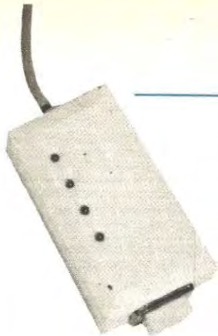
Fig. 1 Il preamplificatore-miscelatore descritto in questo articolo andrà applicato direttamente sul palo di sostegno delle antenne sfruttando come ingressi per tali antenne i quattro cavi coassiali di sinistra. I tre cavi coassiali di destra potremo invece utilizzarli per collegarli l'antenna VHF oppure quella UHF per il 2° programma RAI. Se quest'ultima antenna dispone di preamplificatore dovremo utilizzare il solo cavo coassiale posto al centro lasciando inutilizzato il rimanente.
