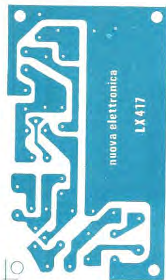
Fig. 2 Circuito stampato a grandezza naturale necessario per la realizzazione di questo prova-zener.
