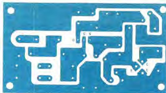
Fig. 2 Circuito stampato LX.303 riprodotto a grandezza naturale.
