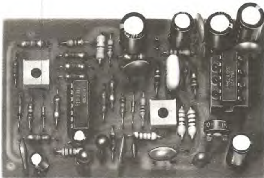
Foto del nostro prototipo montato sul circuito stampato LX.278. Si notino i due trimmer, miniatura ad alta stabilità termica e gli integrati montati su zoccolo.
