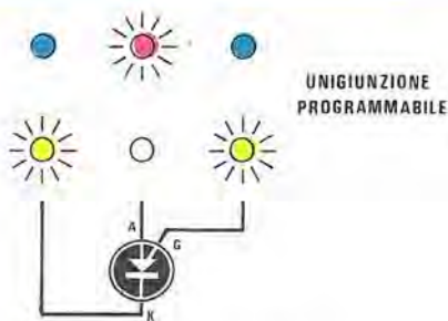
Fig. 7 Applicando al nostro circuito un UNIGIUNZIONE PROGRAMMABILE si accenderanno i diodi led sopra indicati. Quello «rosso» ci individua subito il terminale dell'ANODO.
