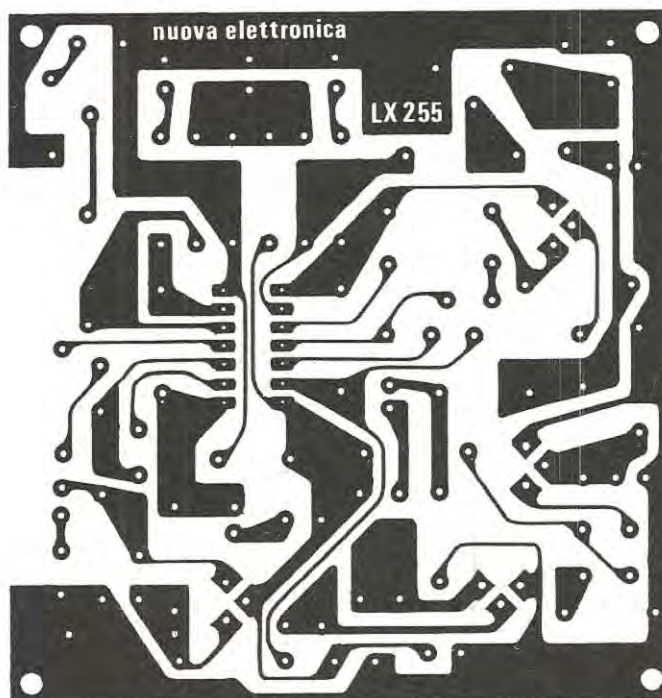
Fig. 5 Di lato il circuito stampato a grandezza naturale che noi vi forniremo già forato e completo di disegno serigrafico dei componenti.
