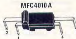
Fig. 3 L'integrato MFC.4010.A si presenta in una forma un po' insolita, almeno per quanto riguarda la disposizione dei terminali. A sinistra (vedi gradino di riferimento) avremo i terminali 1-2 dalla parte opposta il 4-3.
