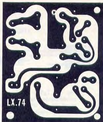
Fig. 28 Disegno a grandezza naturale del circuito stampato dell'alimentatore.
