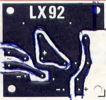
Fig. 9 A sinistra - circuito stampato a grandezza naturale dell'alimentatore. A destra - forma e dimensioni dell'integrato stabilizzatore di tensione \mu A.7812 impiegato in questo alimentatore. I tre terminali E-M-U identificano, terminale d'ENTRATA, MASSA, USCITA STABILIZZATA.
