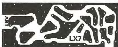
Fig. 2. Disegno a grandezza naturale dei due circuiti stampati LX7 e LX7-BIS. Per i lettori meno esperti in montaggi miniaturizzati consigliamo il secondo montaggio, cioè l'LX7-BIS più semplice da realizzare in quanto tutti i componenti sono posti in posizione orizzontale. I due circuiti stampati sono realizzati su supporto in fibra di vetro per UHF.
