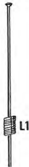
Fig. 9. Per le antenne a stilo caricate con una bobina compensatrice per eliminare le onde stazionarie sarà necessario modificare il numero delle spire della bobina in più o in meno in modo da ottenere il minimo di onde stazionarie.
