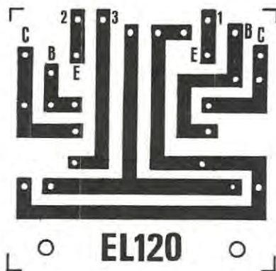
Fi. 3 In basso. Circuito a grandezza naturale del circuito utile a ricevere i componenti del multivibratore astabile.
