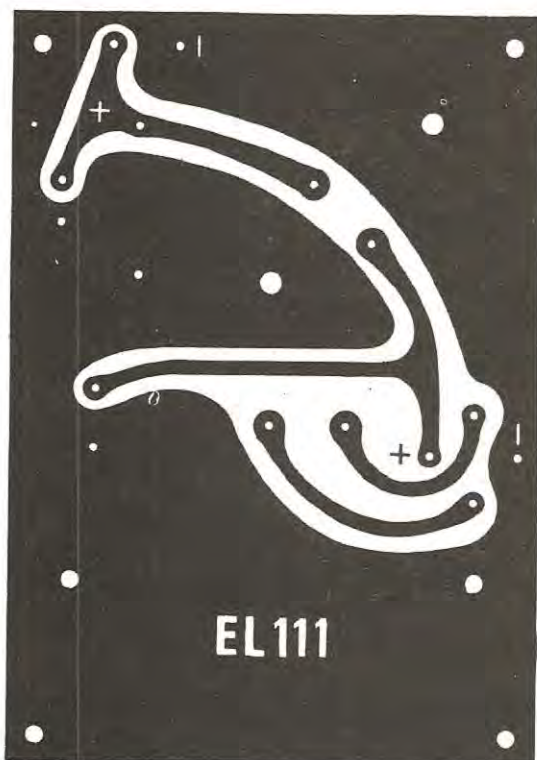
Fig. 5. Circuito stampato a grandezza naturale. Il lettore può richiedere alla nostra redazione il circuito già inciso su fibra di vetro al prezzo di L. 800 piú spese postali.
