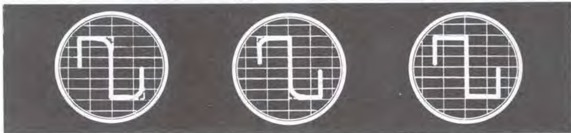
Fig.12 Applicando sull'entrata di un'amplificatore un'onda quadra da 1.000 Hz. se questo è perfetto in uscita l'onda quadra risulterà regolare.
