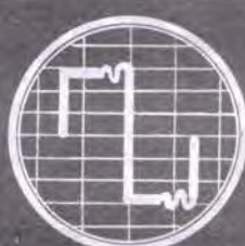
Fig. 11 Se le deformazioni sono presenti sulla destra dell'onda quadra, l'amplificatore innesca sulle frequenze dei bassi.
