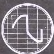
Fig. 9 Quando l'amplificatore attenua in modo esagerato le frequenze Alte l'onda quadra risulterà deformata come in figura.
