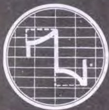
Fig. 8 Un'onda incurvata al centro e mancante degli spigoli di destra denota distorsione sia sulle frequenze Alte e Basse.
