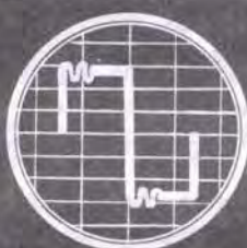
Fig. 10 Se l'amplificatore presenta inneschi sulle frequenze alte appariranno sulla sinistra dell'onda piccole deformazioni.
