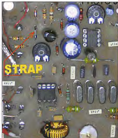
Photo 4 - Vue du filtre à quartz homemade 10,240 et de la position du strap.
