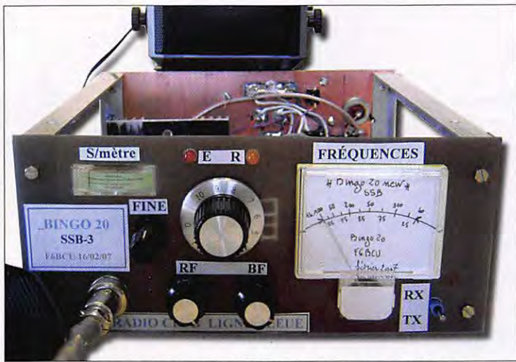
Photo 1 - Le Générateur SSB BINGO équipe ce transceiver BINGO 20.
