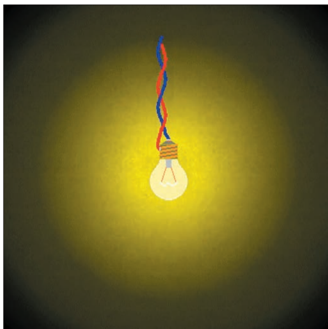
1 – Le rayonnement isotrope d'une ampoule nue.
