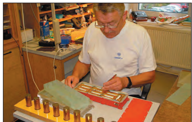
13 - Assemblage d'un module batterie.
