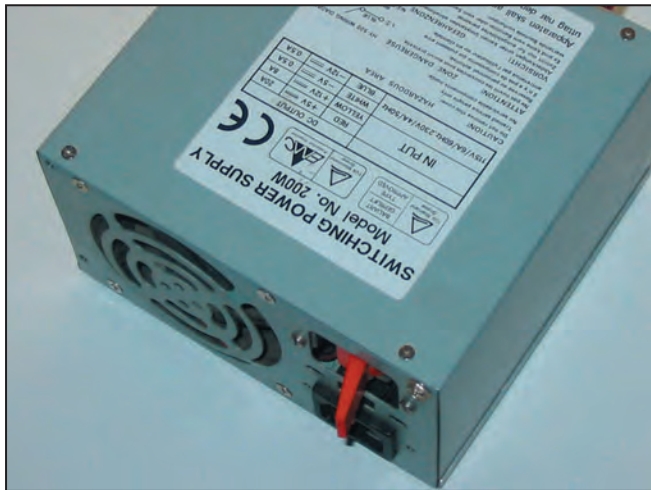
Photo 9: Un interrupteur marche arrêt a été monté à la place de la sortie 220 V inutilisée.
