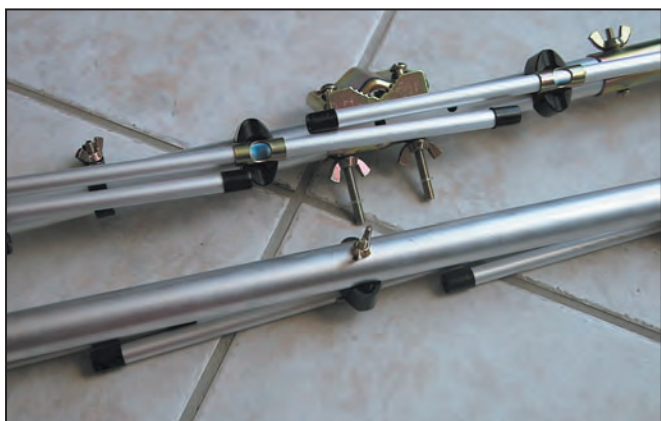
2 - Les éléments se replient le long du boom pour un transport facile.
