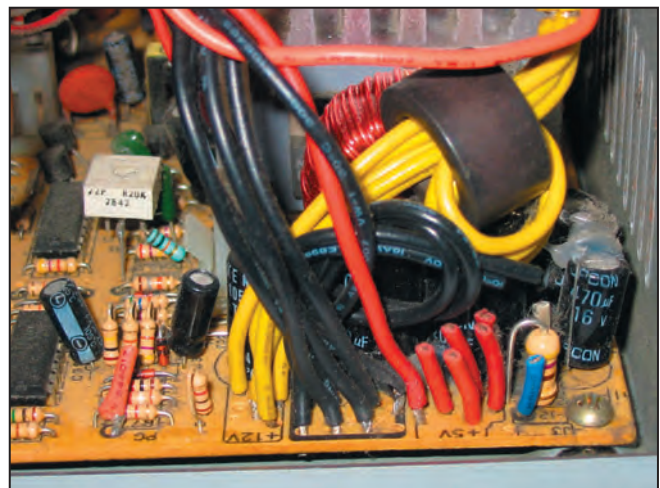
Photo 6 : Les fils rouges (5 V) sont tous coupés, sauf un. Ce dernier va à la résistance de 5 ohms. Le fil bleu (-12 V) est également coupé. Les fils jaunes (12 V) forment une boucle en passant au travers d'un tore ferrite pour filtrer la sortie.
