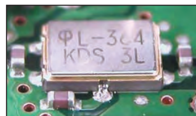
3 - Le "roofing filter" sur 64 MHz (© doc. Icom).
