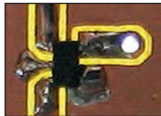
Figure 11: La soudure du LTC1799!
