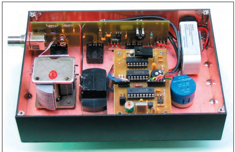
Figure 7 : Une vue de la réalisation de l'auteur, notez le boîtier confectionné en Epoxy
