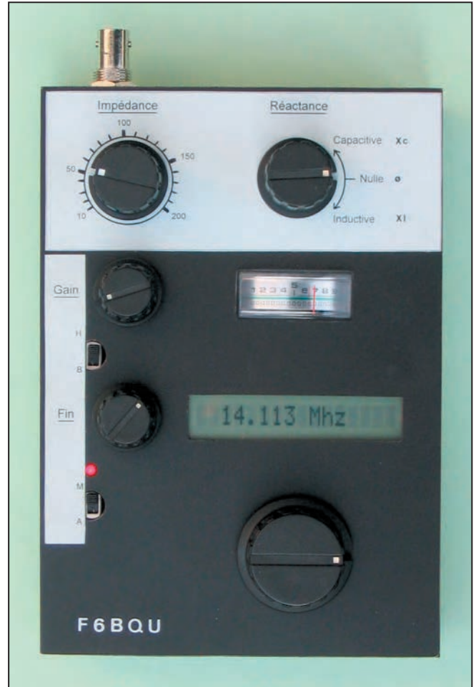
Figure 6 : L'analyseur d'antennes terminé
