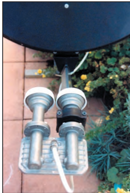
Figure 10: Tête monobloc, Astra en latéral avec DiSEqC.
