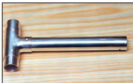
2 - Tubes latéraux et central soudés à la pièce en T.
