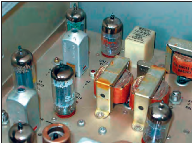
Le générateur SSB du HT44. Noter la symétrie du modulateur phasing.
