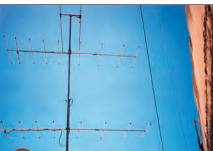
Les antennes de CN2DX: 2x9 él. 144 MHz, 2 él. 50 MHz, dipôle HF.
