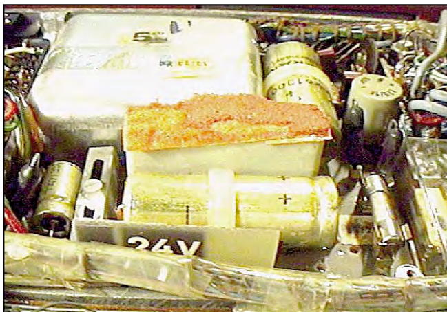
Photo 4 : L'alimentation du KF 450. Pour passer de 12 V à 24 V, il suffit de retourner la plaquette en circuit imprimé marquée "24 V" sur l'image.
