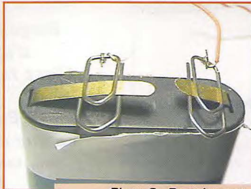
Photo 6 - Branchement de la pile.
