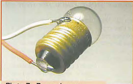
Photo 7 - Raccordement de l'ampoule.
