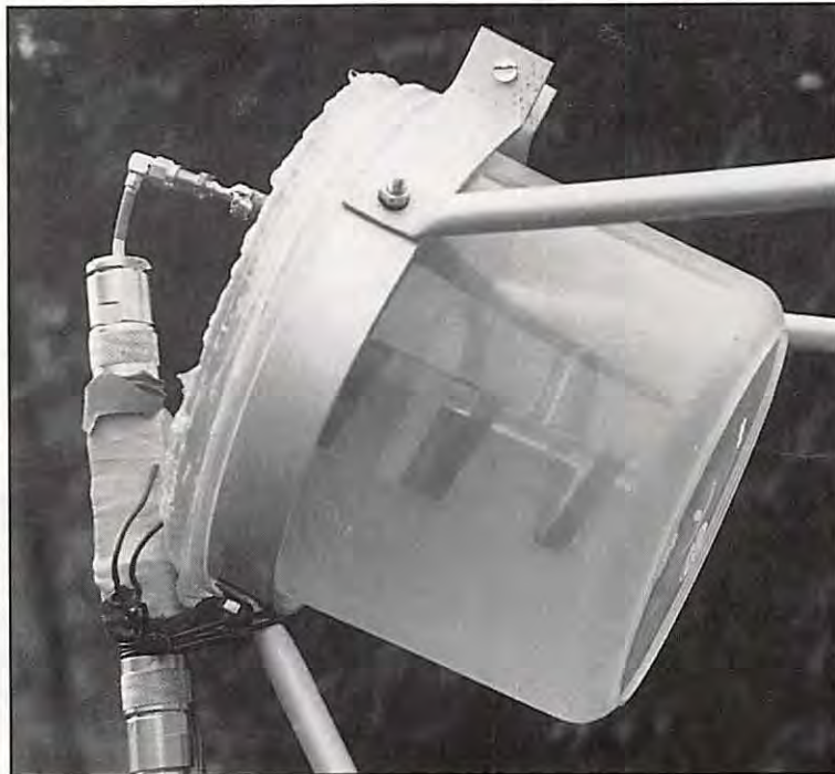
Source circulaire 3 spires par F/D = 0,5 détail de la fixation par cerclage + tripode
