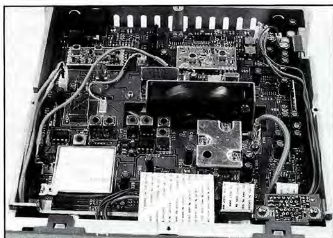
Un ventilateur est présent à l'intérieur du transceiver (d'où le dissipateur assez réduit).
