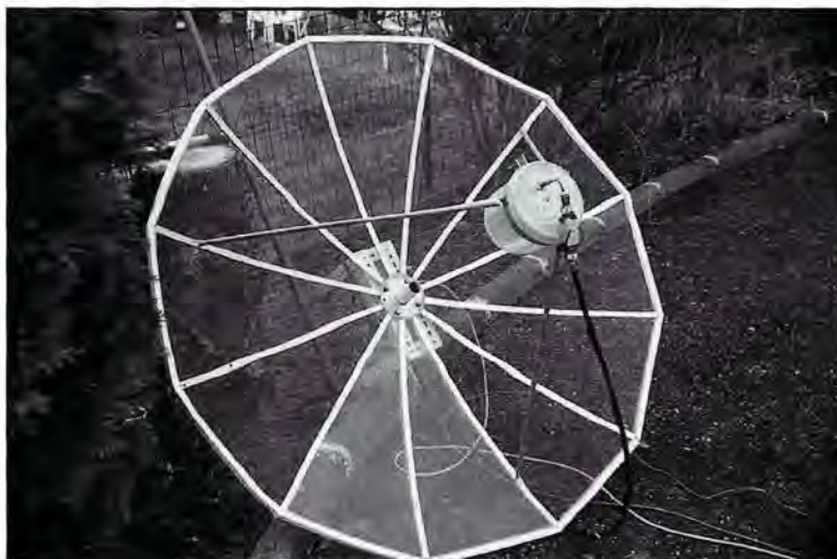
Parabole en cours de test et de mesure.
