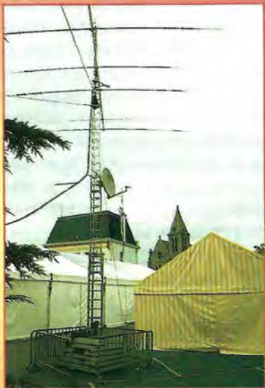
Au premier plan : pylône prêté par F1HOL (CTA) avec la beam Create 6 éléments, l'omni 144. En arrière plan sur les deux cheminées du bâtiment face à l'église, les antennes 144, 432 pour les VHF et l'ATV (la régie technique ATV était à la fenêtre où pénétraient les câbles).
