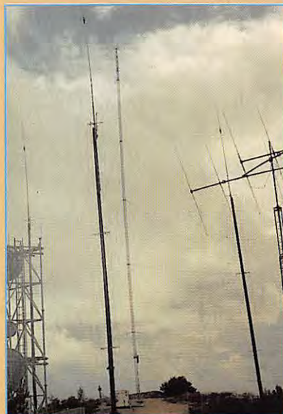
4 él. vertical array pour 160 m.
