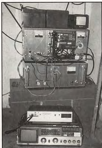
Le relais ATV et son. En bas, un récepteur TV de contrôle 1255 MHz.
