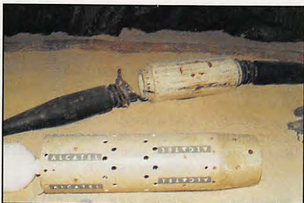
Un câble sous-marin et son répéteur.
