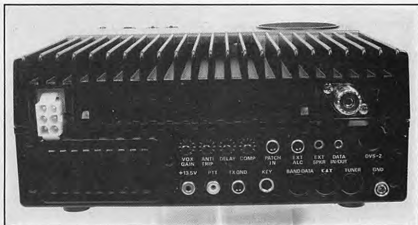
Le panneau arrière du FT-890. Prises et commandes sont accessibles facilement.
