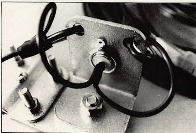
Fixation du brin rayonnant par système pivotant permettant d'aligner au mieux l'axe du brin rayonnant.
