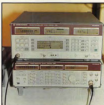
Rohde & Schwartz : un grand nom de la mesure. Générateur et analyseur de modulation.
