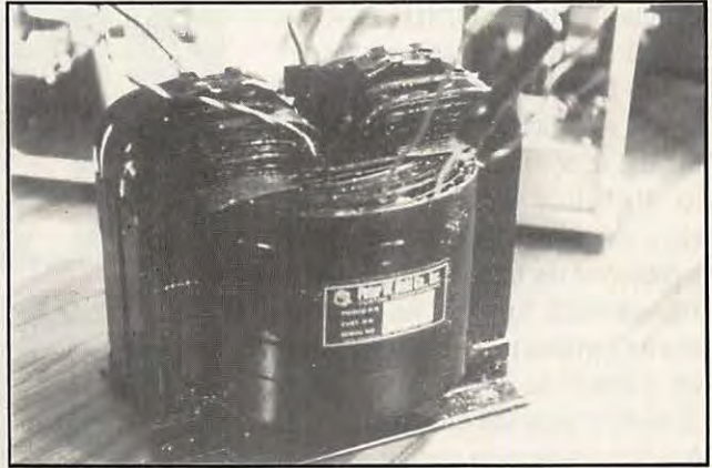
Le transformateur HT.
