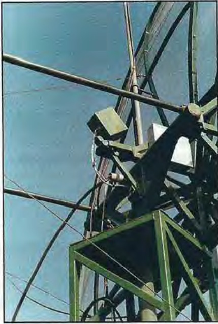
Au centre de la photo, le moteur de site et son cric.
