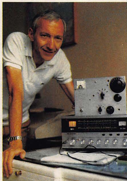
XE1MD à côté d'un émetteur à quartz CW de 50 W, fabrication maison (R.A. Handbook ARRL 1968) et d'un récepteur Réalistic 150A installés chez Angelo, XE1VE en 1986.
