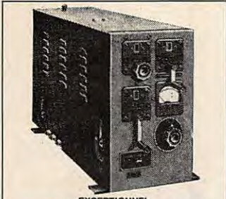
EXCEPTIONNEL BOITE D'ACCORD ANTENNE USA BC 939 Fonctionne de 2 à 21 MHz - 1 kW HF admissible - Equipée avec 3 selfs à roulette en métal argenté sur stéatite soit une de 60 spires en \varnothing 82 mm, une de 24 spires en \varnothing 51 mm et une de 5 spires en \varnothing 30 mm. Avec compteurs au 1/10 e de tour par spire avec ampèremètre HF de 15 A et 2 capas sous vide 20 kV - Très beau coffret métal de 25 x 27 x 56 cm - Prix 835 F
