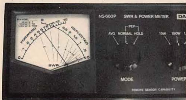
Photo 6 : La mesure en BLU avec un TOS de 3.
