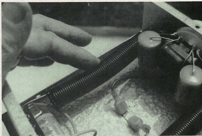
Montage des selfs "en l'air"
