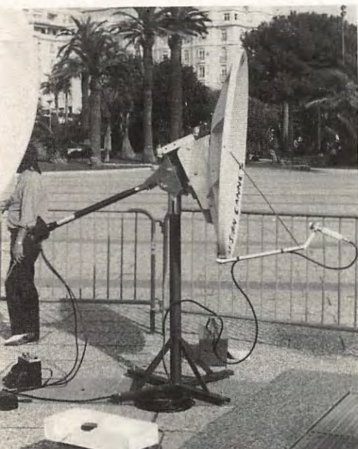
Vue d'ensemble d'une parabole offset 1. 20 m MASPRO motorisée.
