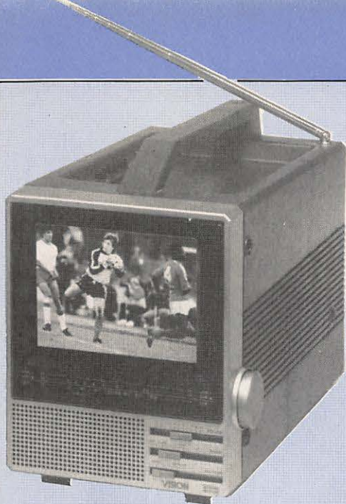
Photo 1 Mini TV couleur multistandard PAL/SECAM, écran 14 cm de diagonale. 220 volts/15 volts, consommation 25 W permettant les réception en VHF des canaux A.B.C. de 1 à 6 et E7 en UHF des canaux 21 à 69, sensibilité 10 microvolts en VHF et 14 microvolts en UHF.
